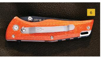
del ATB, puesto que separando el tornillo trasero que asegura las cachas (con una pequeña pieza de acero unida a su fiador y que reproduce el logotipo oval de Muela), pueden girarse éstas para disponer de otra herramienta útil para muchos supuestos y hasta de una plancha pulida de metal que puede actuar como heliógrafo de supervivencia.
