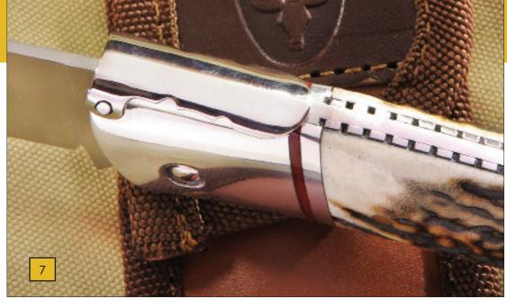
>> Un detalle de la palanquilla de bloqueo y del acabado impuesto al lomo del mango de esta navaja, confirma el buen trabajo efectuado por los excelentes artesanos que ejercen su labor en la fábrica Muela de Argamasilla de Calatrava (Ciudad Real).
